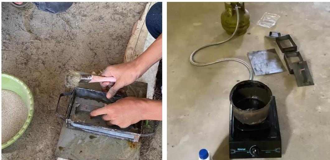
**Gambar 1.** Pencetakan Paving Blok
